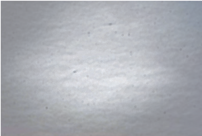
Er zijn stofvlekken op de sensor zichtbaar: deze sensor moet dringend schoongemaakt worden.
